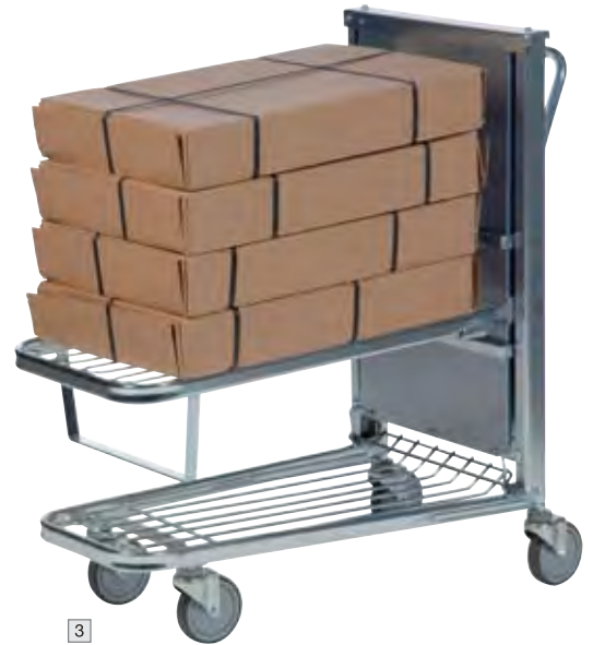
3 • Oberer Boden 810 mm hoch, federnd gelagert • Die Arbeitshöhe ist abhängig vom Gewicht der Ware - bei 100 kg Belastung senkt sich der obere Boden auf die niedrigste Position ab
