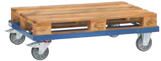
1 • Ohne Fangecken • TPE-Bereifung, Rad-Ø 160 mm, Naben mit Rillenkugellager • Ladehöhe 216 mm
