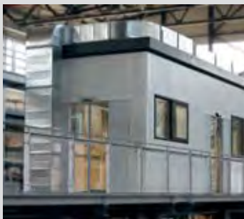
Individueller Maschinenstand auf Bühnenkonstruktion. Ausstattung mit Lüftung, Schiebetüren und Schallschutz. Aufstellung im Innenbereich.
