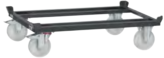
3 • Mit 4 Fangecken • Polyamid-Bereifung, Rad-Ø 200 mm, Naben mit Rollenlager • Ladehöhe 282 mm
