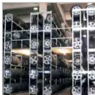
Zweigeschoss-Regalanlage mit Stufenbalken für die Einlagerung von 40.000 Kompletträdern
