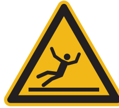
1 Warnung vor Rutschgefahr
